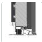
Seuil aluminium 20mm vue coupe basse
