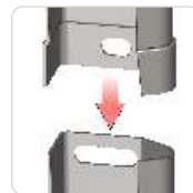
Manchonage du rail
