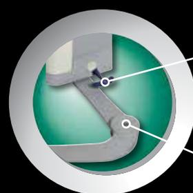
Système de déverrouillage manuel en cas d'absence de courant
