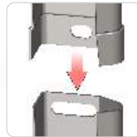
Manchonage du rail
