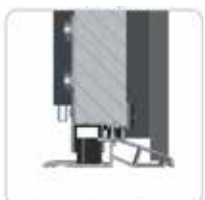
Seuil aluminium 20mm vue coupe basse
