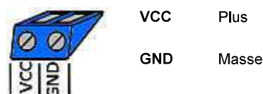
Fig. 2: Raccordement à l'alimentation en tension (bleu)
