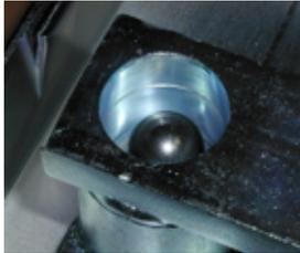
Insérer la bille de roulement en acier trempé après l'avoir graissé.
