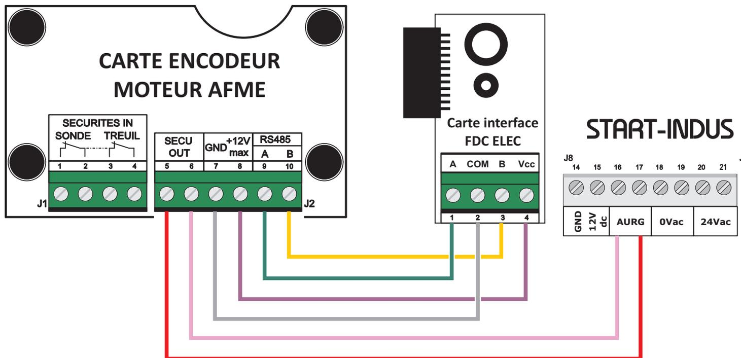
Raccorder impérativement la sortie SECU OUT sur l'entrée arrêt d'urgence de la carte Start-Indus.
