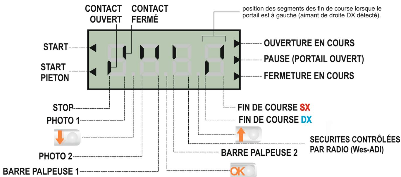
Ce panneau de contrôle signale l'état physique des contacts reliés au bornier et des touches de programmation.
