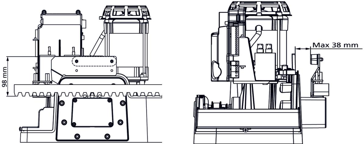
Placer l'étrier porte-aimant fourni sur la crémaillère de manière que dans les positions d'ouverture et de fermeture l'aimant reste positionné à hauteur du capteur magnétique placé sur le moteur.
