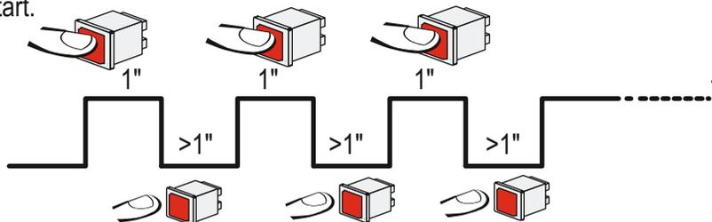
**Remarque:** si le paramètre **Strt** est configuré sur **StAN**, la commande START provoquera à tour de rôle l'ouverture puis la fermeture.
