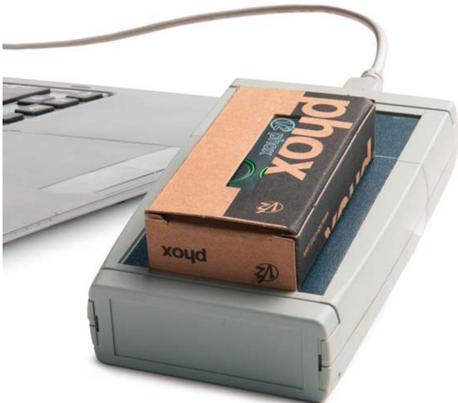
Flash-prog V2 pour programmation d'émetteurs Phox .Connexion directe sur l'ordinateur via usb. Programmation par contact inutile de débiller ou de démonter l'émetteur.
