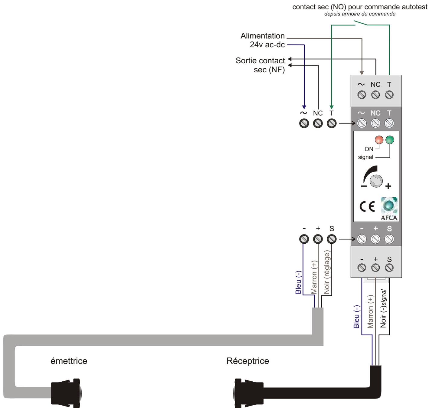
Lorsque le barrage cellule est supérieur à 2m, le réglage de la sensibilité n'est pas nécessaire, de ce fait le raccordement du fil noir de la cellule émettrice n'est pas obligatoire.
