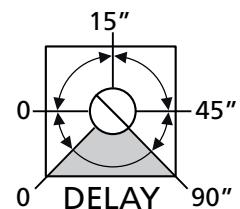
**DELAY:** tempo de ralentización entre os dois batentes (0 ÷ 90 segundos)
