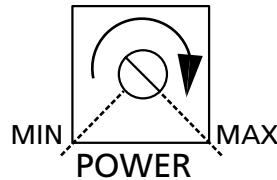
**POWER:** siła ciągu napędu
