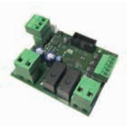
AX SYNCLUX Module pour la gestion de bandes lumineuses RGB ou pour le fonctionnement synchronisé de 2 barrières Code 163676
